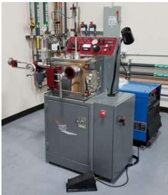
18 Сурет - «Arc 200» маркалы сумен салқындатылатын мыс тигелді зертханалық вакуумдық электр доғалы пеш
